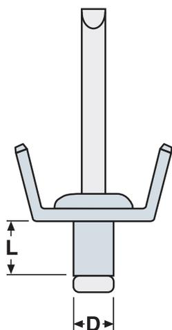
Il rivetto massa è il sistema più rapido per effettuare dei collegamenti di messa a terra su strutture metalliche. Viene prodotto in tre versioni: a 1, 2, 4 terminali. Le dimensioni dei terminali sono 6,3x0,8 e sono conformi alla norma DIN EN 61210 (VDE 0613 P. 6).
